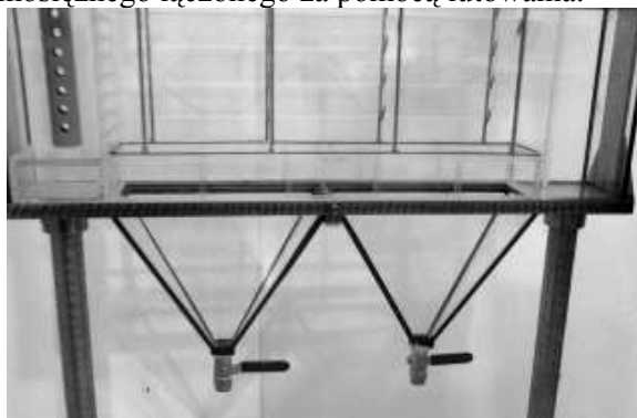
Rys. 8.9. Komory (leje) do zbierania osadu
