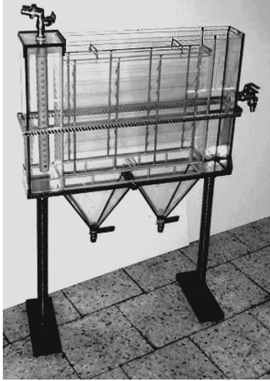
Rys. 8.4. Stanowisko badawcze – osadnik i konstrukcja wsporcza
